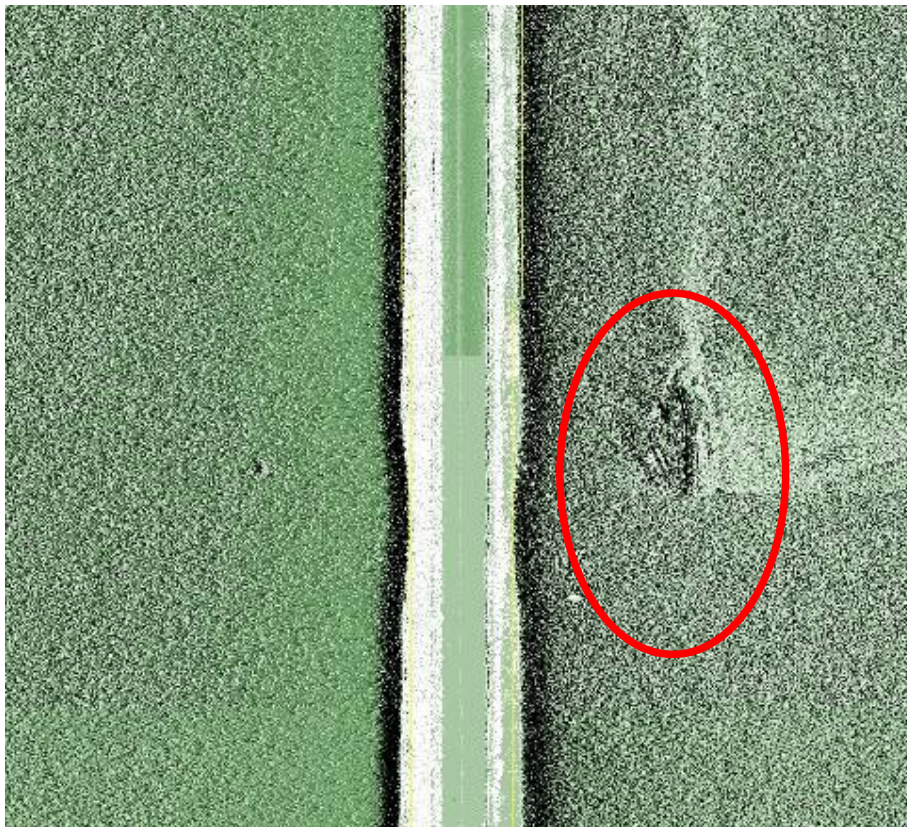
Figura 5 - Imagen de Sonar de barrido Lateral, destacándose sobre Estribor sobre el fondo regular, como único contacto al Naufragio Patria
