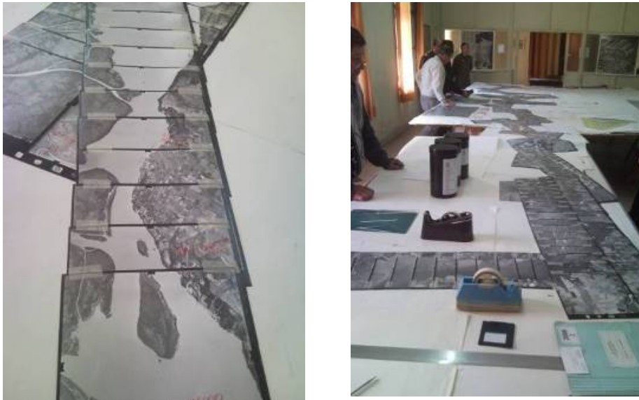
Figura 6 – Fotomosaico resultado de los vuelos fotogramétricos realizados.
