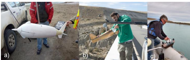
Figura 3.- Muestreadores a) US D-96, b) US D-77 y c) Niskin.
