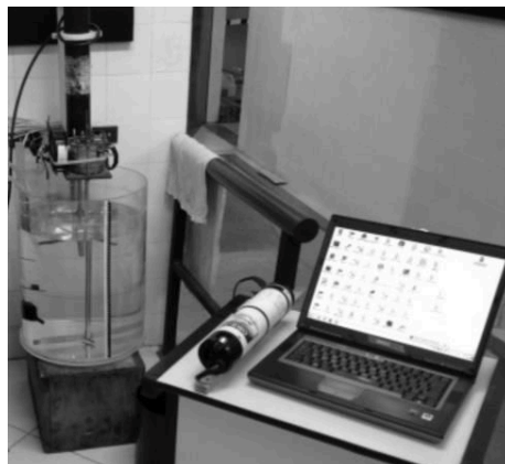
Figura 1.- Disposición del aparato instrumental utilizado en los experimentos, tanque de acrílico y OBS.
