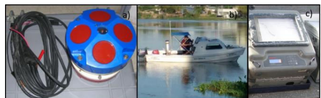
Figura 2.- a) ADCP Río Grande Teledyne RD Instrument 1200 kHz, b) Embarcación hidrográfica y c) Ecosonda Raytheon simple haz
