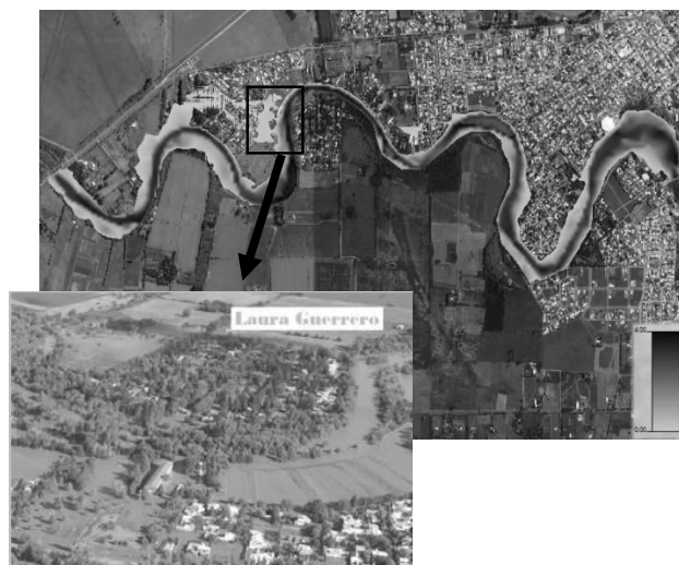
Figura 4.- Campo de profundidades a lo largo del tramo Villa María para el caudal de 375 \text{ m}^3/\text{s} - HEC RAS 2D. En la figura también se muestra una imagen área del Barrio Vista Verde, seriamente afectada por la inundación de febrero de 2014.
