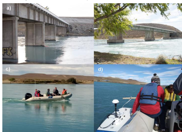
Figura 2.- Estaciones de aforos desde puente (a): La Leona y (b): Charles Fhur y (c) y (d) embarcación utilizada en estaciones Condor Cliff, Barrancosa y Piedra Buena.
