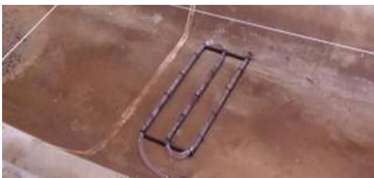
Figura 5.- Esquema de disposición de cañería e inyectores en canal de laboratorio
