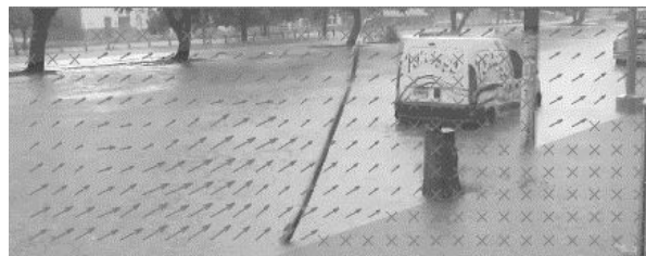
Figura 2.- Campo de velocidad media superficial obtenido mediante LSPIV en el caso 1.
