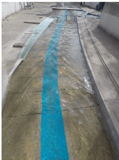
Figura 4.- Ondas cruzadas en modelo físico del nuevo puente.
