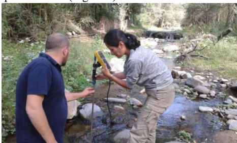
Figura 4.- Medición de caudal mediante el uso de un Velocímetro Acústico Doppler
