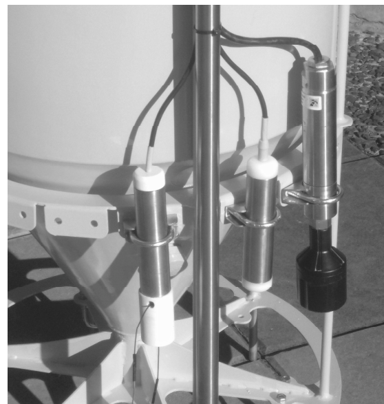
Figura 3.- Anillo de montaje de los sensores en la boya.
