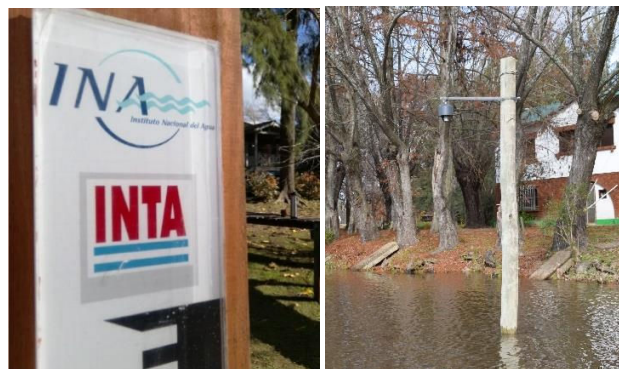
Figura 2.- Regla hidrométrica en el Río Carapachay (izq) y sensor de nivel en el arroyo Marín (der) en el Delta del Paraná.
