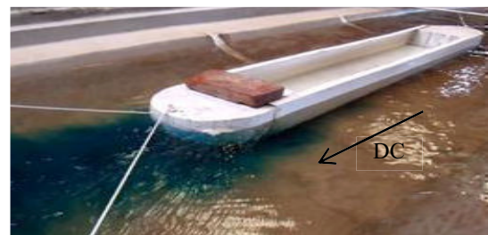
Figura 2.- Embarcación amarrada en corriente de agua y colorante inyectado en la proa.
