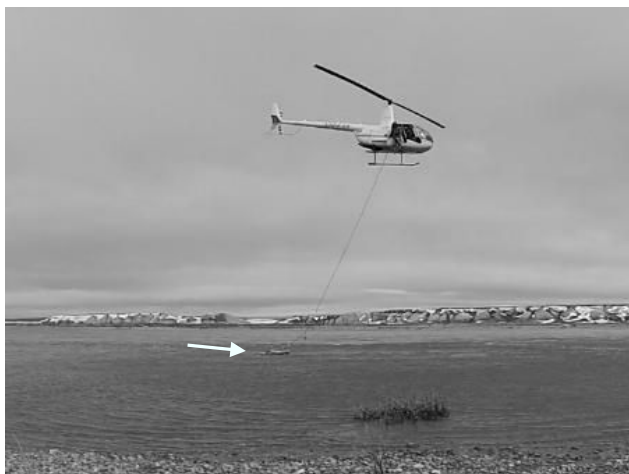
Figura 5. Pequeño trimarán que contiene un ADCP (indicado por la flecha) siendo remolcado a través del río por el helicóptero realizando las mediciones de caudal durante el deshielo.
