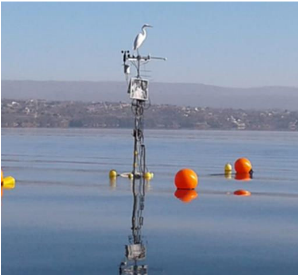
Figuras 3 y 4.- Estación de Monitoreo de Lagos (EML) instalada en el San Roque desde 2018 y sensores meteorológicos de superficie.
