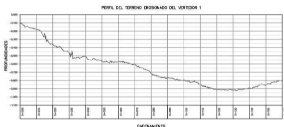
Figura 4.- Perfil del terreno erosionado del vertedor 1.
