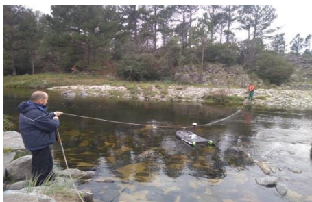
Figura 3.- Medición de caudal mediante el uso de un Perfilador de corriente acústica Doppler
