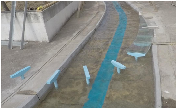
Figura 3.- Modelo físico E_L=1:40 del nuevo puente sobre el Río Suquía.
