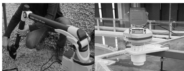
Figura 1.- Scanner láser 3D Hexagon® y sensor de nivel Siemens®.
