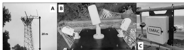
Figura 1. Instalación de equipo. A) Torre de instalación del equipo. B) Configuración de posicionamiento de las cámaras. C) Gabinete de adquisidor de datos.
