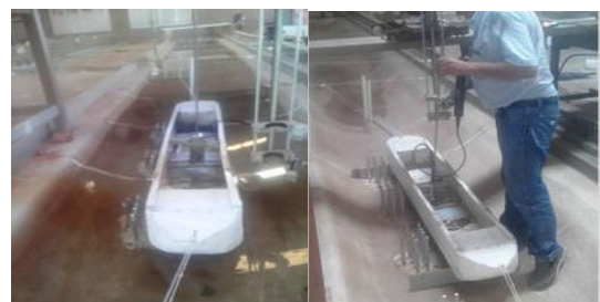
Figura 8.- Mediciones de la hidrodinámica a fondo fijo con buque.
