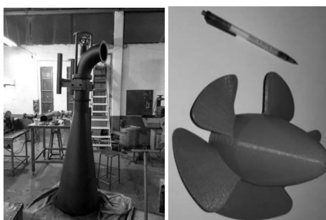
Figura 5.- Rodete turbina hélice de impresión 3D y turbina terminada.
