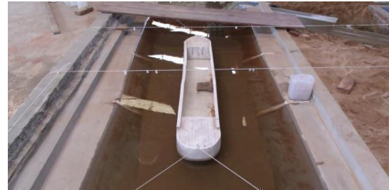
Figura 1.- Canal con fondo de arena y modelo.
