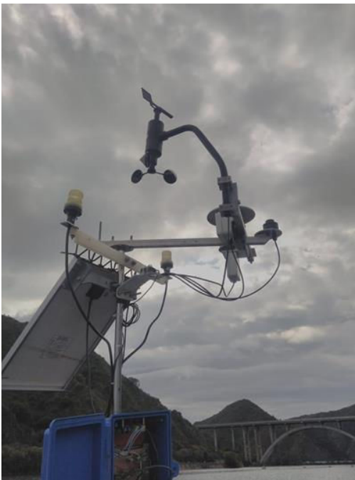
Figuras 3 y 4.- Estación de Monitoreo de Lagos (EML) instalada en el San Roque desde 2018 y sensores meteorológicos de superficie.
