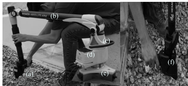
Figura 2.- Partes del scanner láser 3D: (a) Scanner, tiene modo escáner y palpado de la superficie; (b) brazo articulado, facilita la manipulación y acceso a zonas estrechas; (c) eje giratorio 360°; (d) batería recargable; (e) base imantada; y (f) modo escáner, la distancia de tolerancia entre la superficie y el escáner es de aproximadamente 15 cm.
