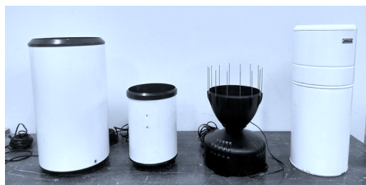
Figura 2.- Pluviómetros ensayados (de izquierda a derecha): TECMES Alto, TECMES Bajo, Davis, y Tipo B
