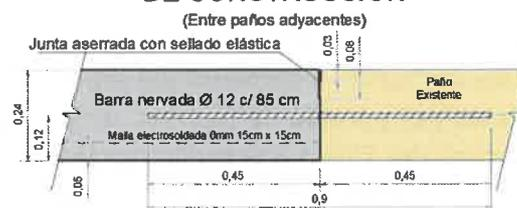
NOTA: En paños existentes, perforar el paño con un Ø 14, limpiar, rellenar con epoxi y luego introducir la barra nervada para su fijación.
