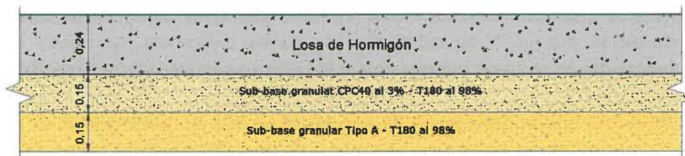
Figura 8: Paquete estructural, losas de hormigón y sub-base granular.
