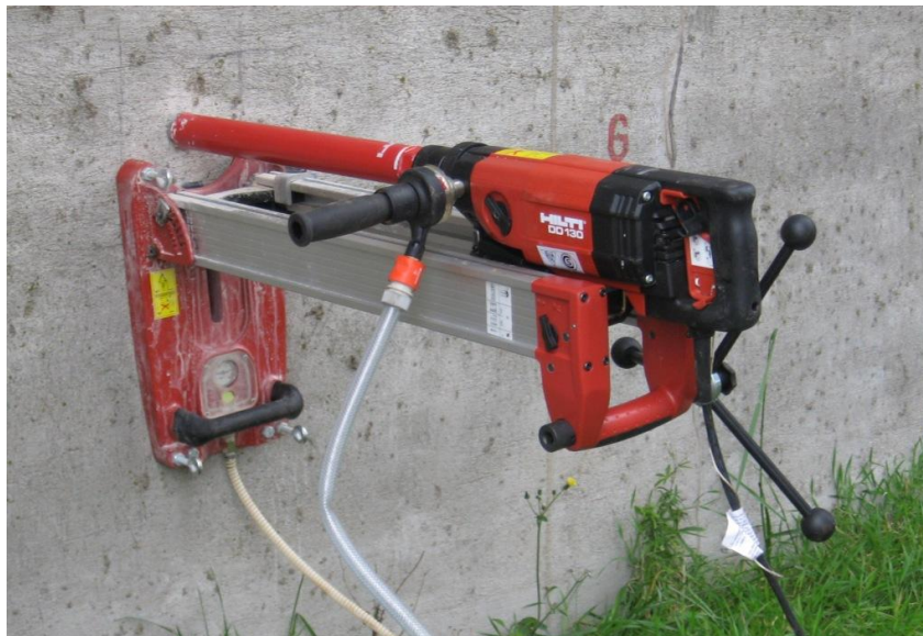
Figura 7. Equipo utilizado para la extracción de testigos.
