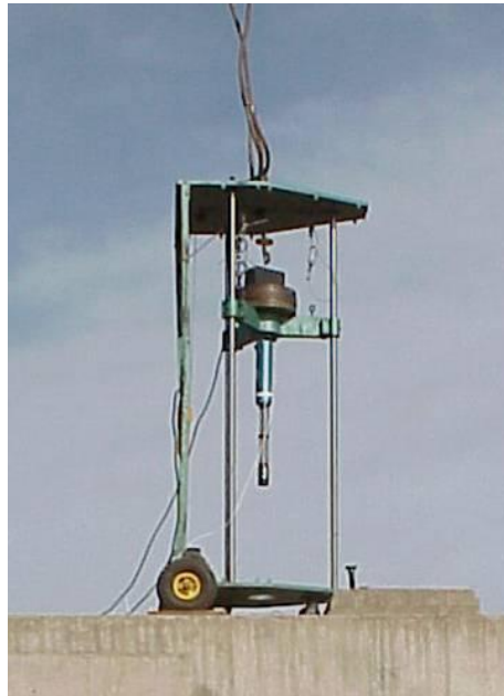
Figura 8. Equipo para aplicación de impulsos sobre el tablero.
