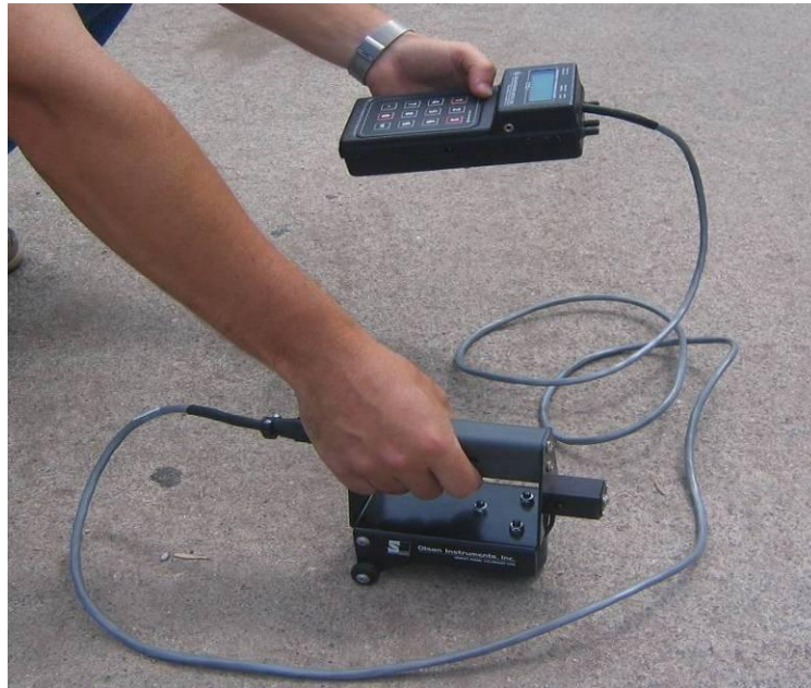
Figura 2. Dispositivo para realizar ensayos pulso-eco en hormigón.
