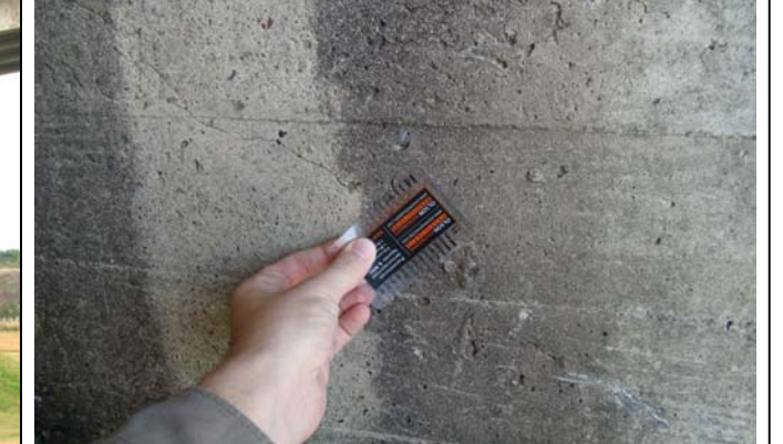
FOTO 4: Cara lateral - Aguas arriba. Ensayo de carbonatación
