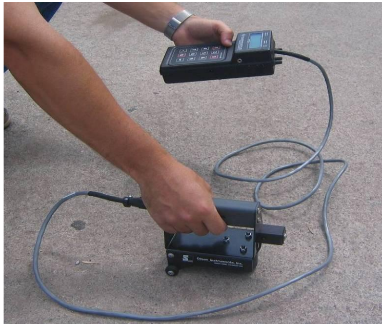
Figura 2. Dispositivo para realizar ensayos pulso-eco en hormigón.
