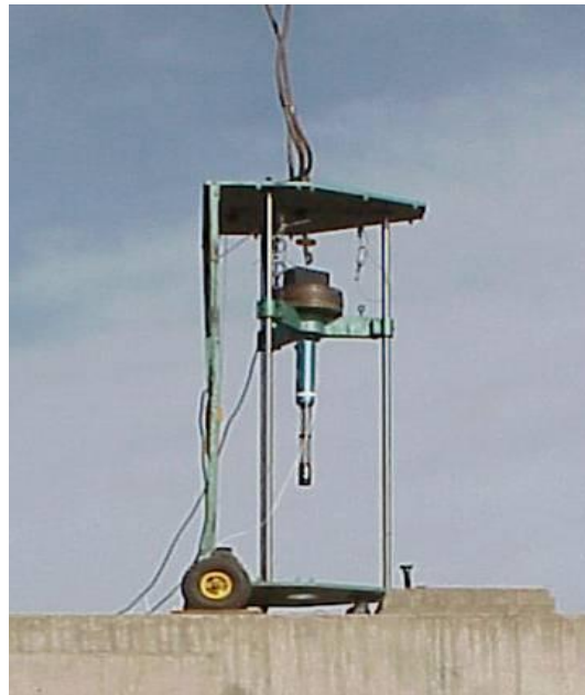
Figura 5. Equipos para aplicación de impulsos sobre el tablero.
