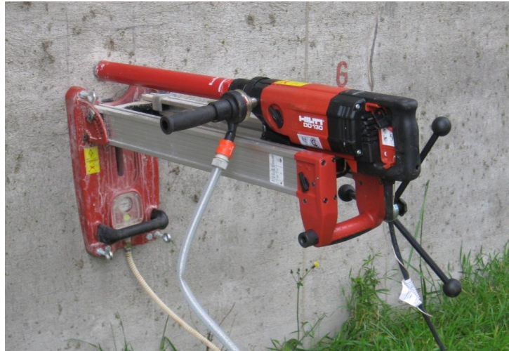
Figura 4. Equipo utilizado para la extracción de testigos.
