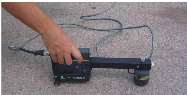
Figura 3. Dispositivo utilizado para realizar ensayos SASW en hormigón.
