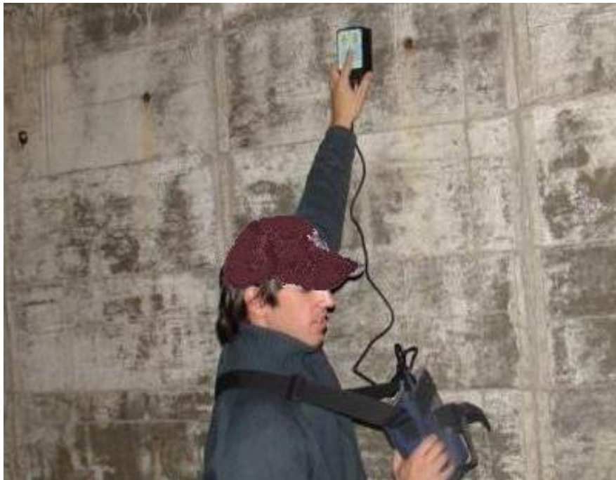
Figura 26. Ensayo para determinar el recubrimiento (Pachómetro).
