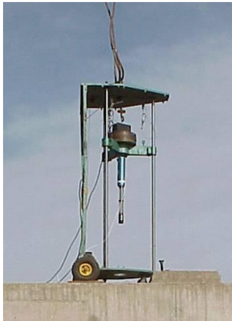
Figura 25. Dispositivo de aplicación de la carga dinámica
