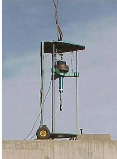
*Figura 21. Dispositivo de aplicación de la carga dinámica*
